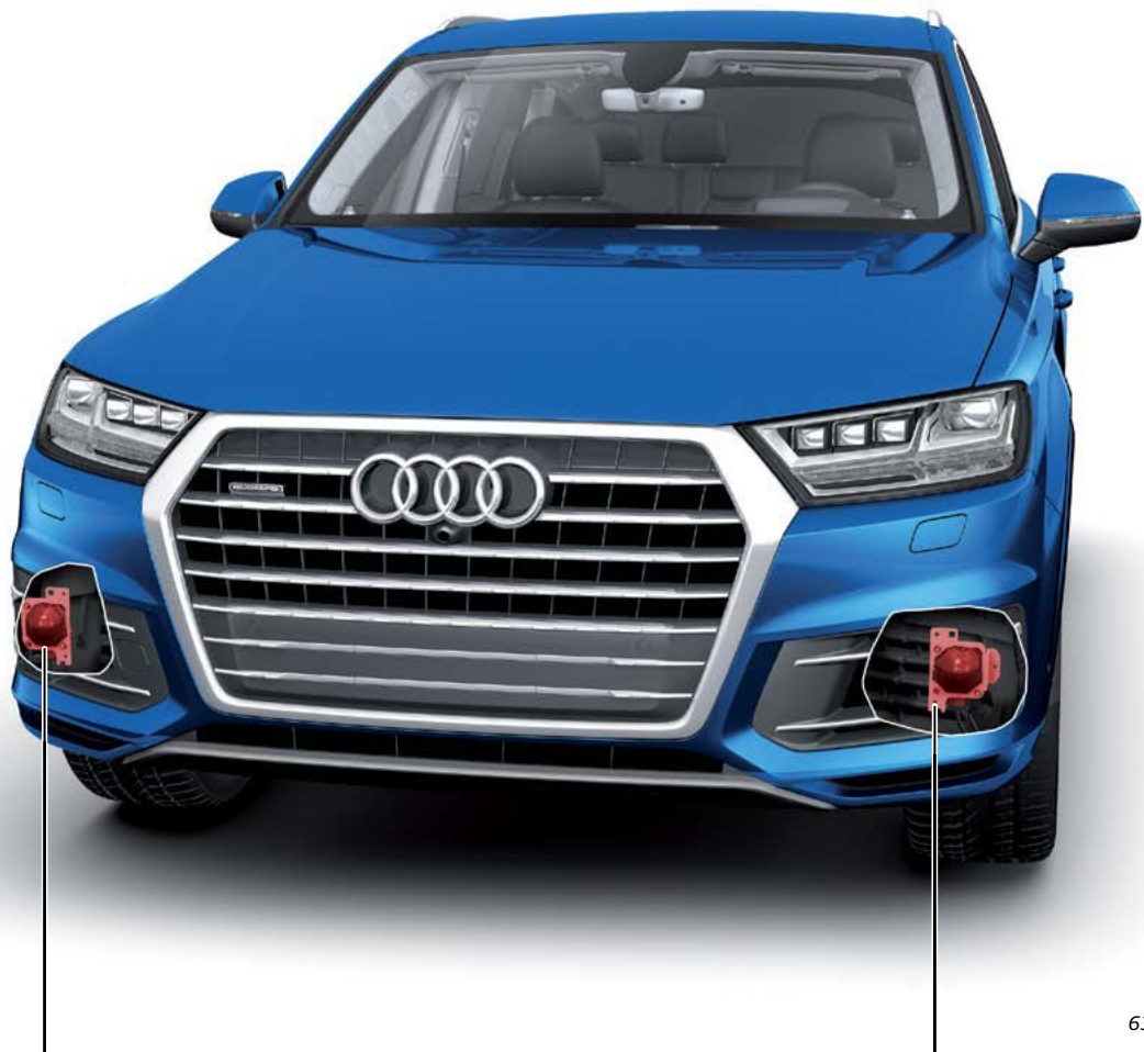
Датчик адаптивного круиз-контроля, правый G259 и БУ адаптивного круиз-контроля J428 (задающее устройство)
