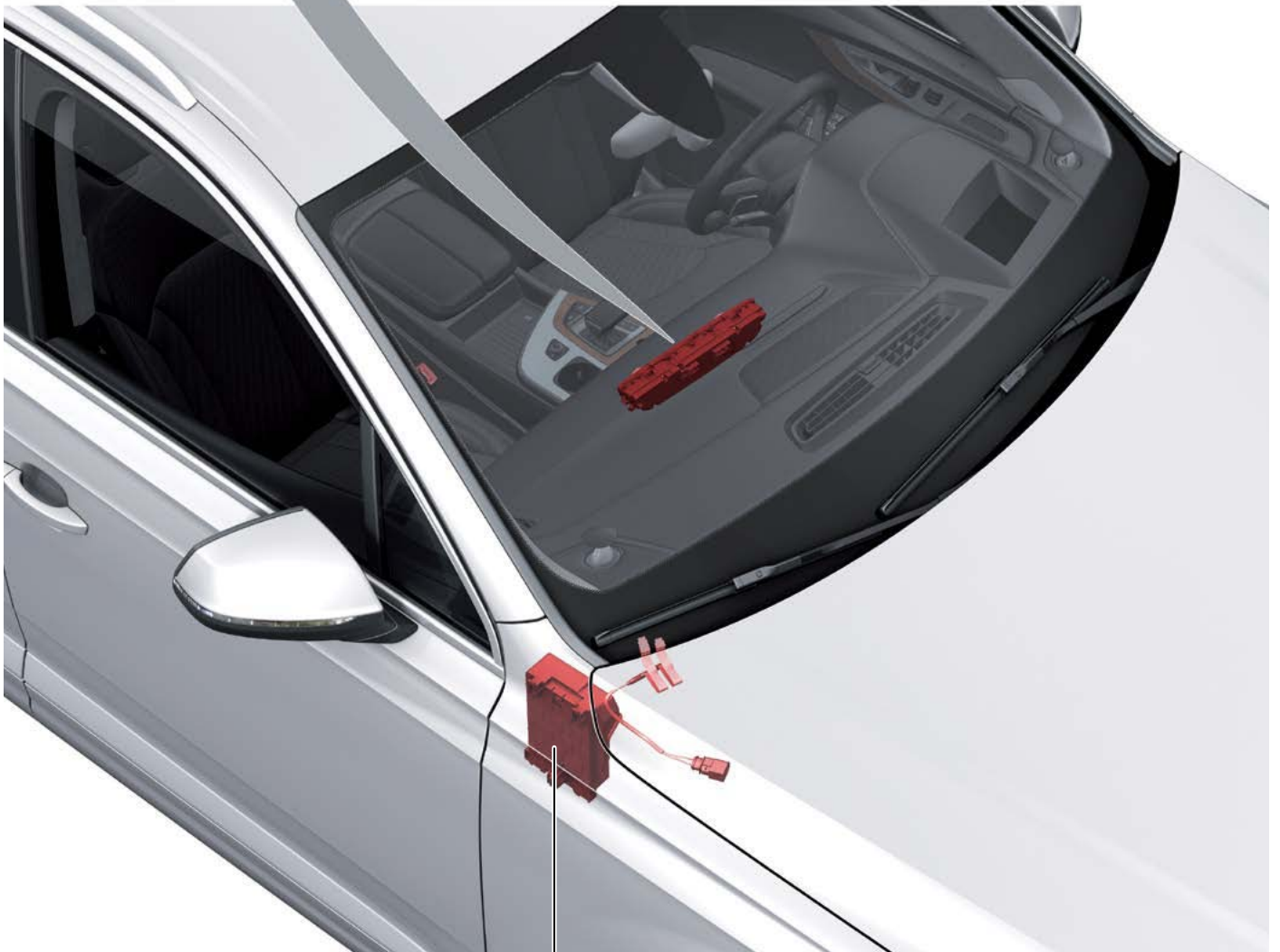
Блок управления обогрева ветрового стекла J505 (преобразователь постоянного тока DC/DC)
