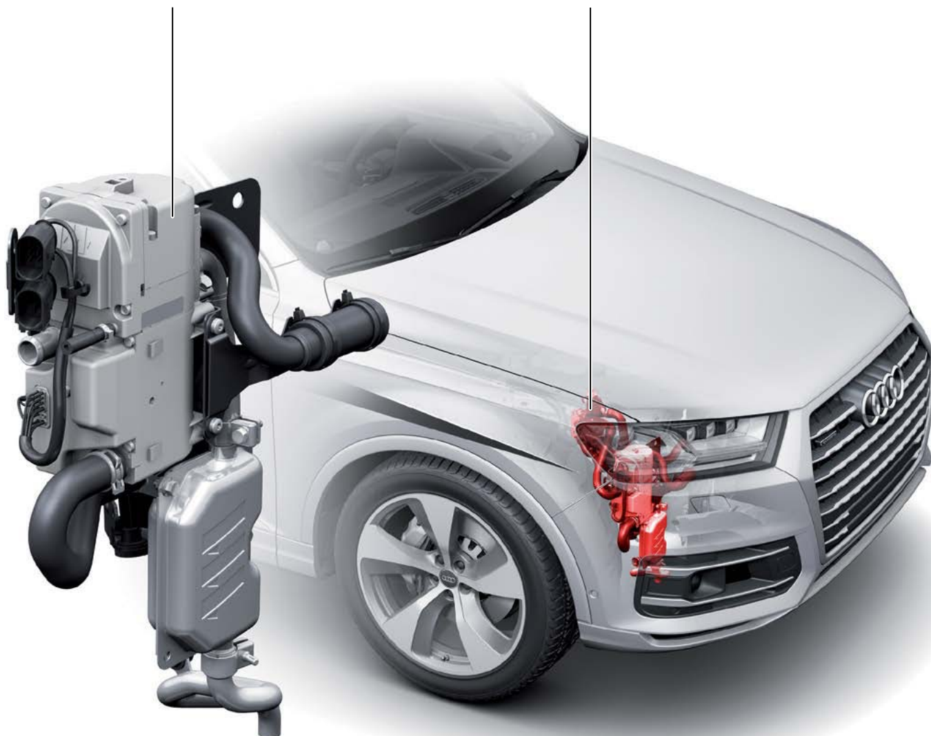
Нагревательный элемент дополнительного воздушного отопителя Z35 с блоком управления дополнительного воздушного отопителя J604
