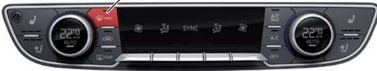
Передняя панель управления и индикации климатической установки E87 с клавишей оттаивания ветрового стекла
